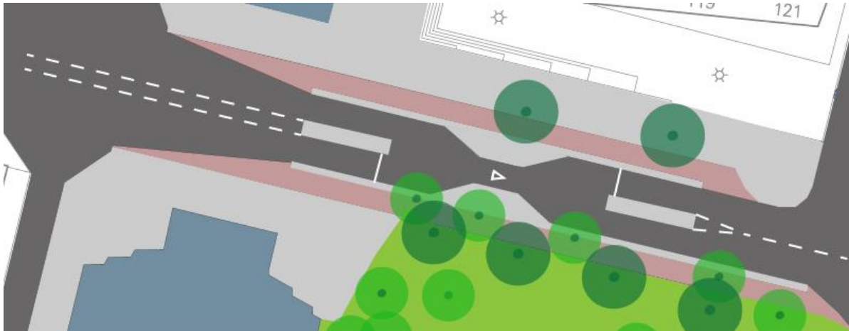
Figuur 4. Voorbeeld ontwerp voor doseren oftewel “knijpen” van het verkeer op de Anne Frankstraat
