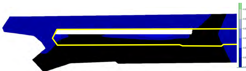
Figuur 3-5: Verschillen in grondwaterstand tussen toekomstige maatgevende freatische grondwaterstand (variant 1B) ten opzichte van de huidige maatgevende grondwaterstanden. De legenda is weergegeven in meter. Op de witte locaties liggen ondergrondse constructies die het freatisch pakket volledig afsluiten (grondwaterstroming niet mogelijk). De waterlijn is aangegeven in geel.
