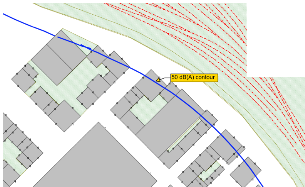
Figuur 6.1: Invloed emplacement, 50 dB(A) contour op 50 m afstand
