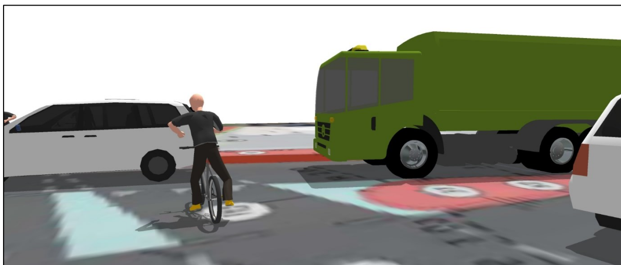
Figuur 3.1: Zichtprobleem voor overstekende fietser/auto ten aanzien van grote voertuigen en fietser op fietsstrook
